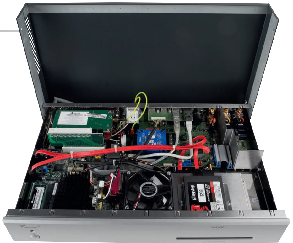
Auf der internen Festplatte sitzt das Betriebssystem, außerdem werden dort Ripping-Daten zwischengelagert. Der Lüfter in der Mitte ist absolut unhörbar
