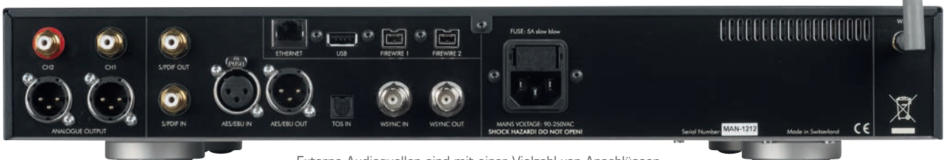
Externe Audioquellen sind mit einer Vielzahl von Anschlüssen einbindbar, sogar externe Clocks können verwendet werden
